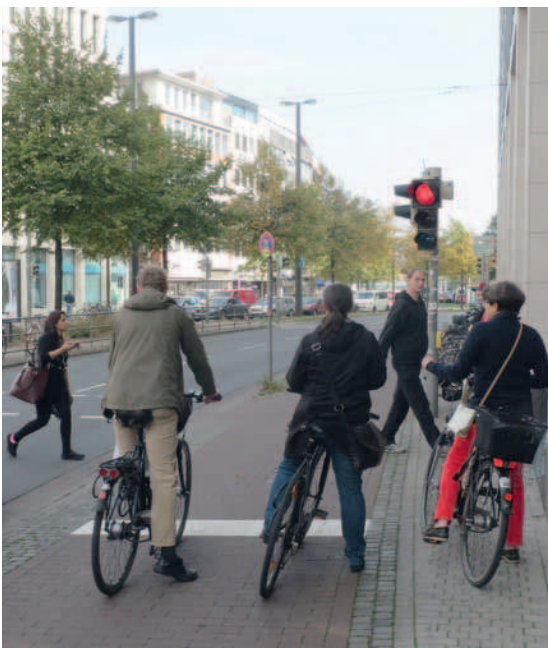
Sichere Fußgängerquerung: Haltelinie auf Radweg – Herdentorsteinweg
