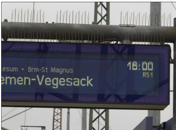
Abbildung 47: Die Darstellung der Abfahrtszeit (hier 16:00 Uhr) auf dem Anzeiger an Gleis 3 in Bremen-Burg war unscharf.
