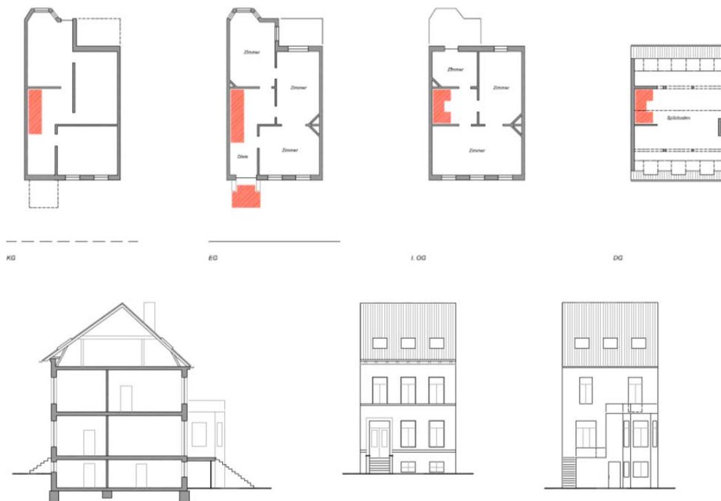
Abbildung 4-49 Schematische Zeichnungen des Gebäudetyp I, Maßstab ca. 1:400
