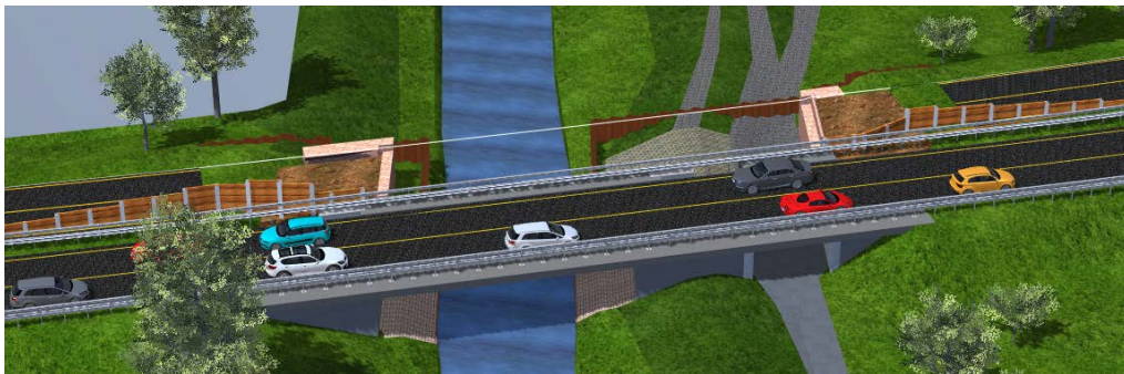
Abbildung 8: Bauphase 2, Verkehr auf fertiggestelltem Teilbauwerk
