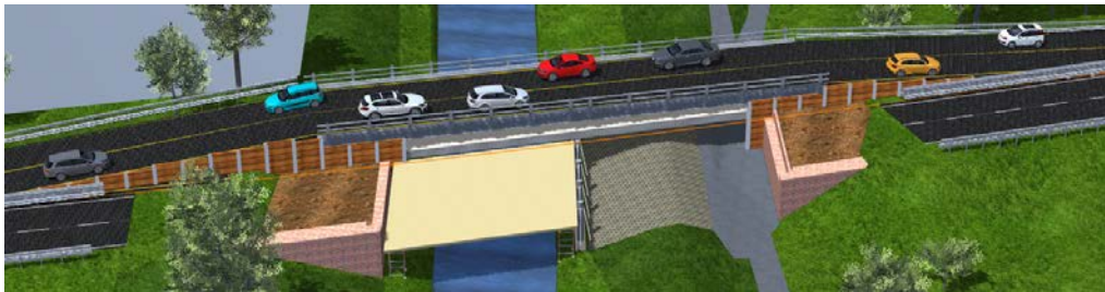
Abbildung 7: Bauphase 1, Verkehr auf Hilfsbrücke
