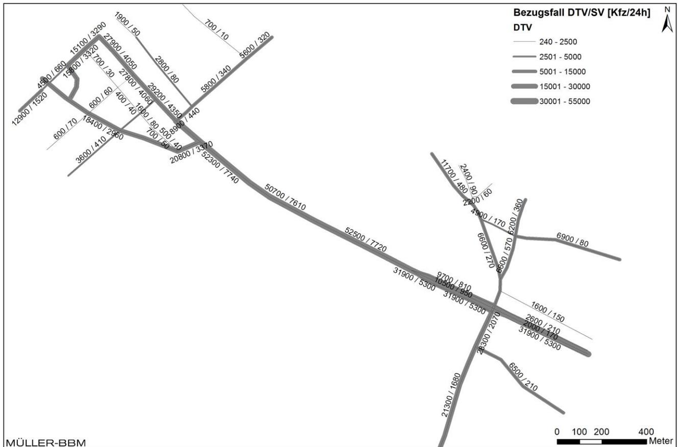
Abbildung 3. Verkehrsmengen im Bezugsfall 2025 (Prognosefall ohne BA 2/2 der A 281) [31]
