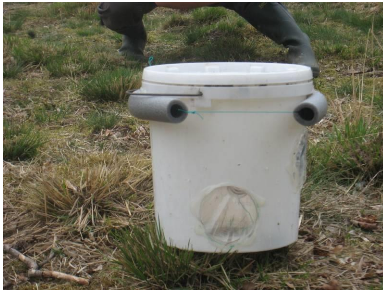
Abbildung 1: Molchfalle; die Tiere dringen durch die trichterförmige Öffnung in den schwimmenden Eimer ein
