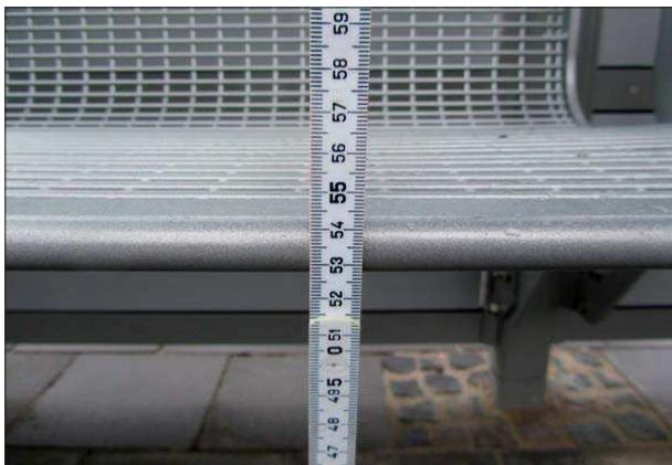
**Abbildung 9:** Die Sitzbänke in den Fahrgastunterständen des Bahnhofs Bremen-St. Magnus sind deutlich höher installiert als die geforderten 45 cm über dem Bahnsteig.
