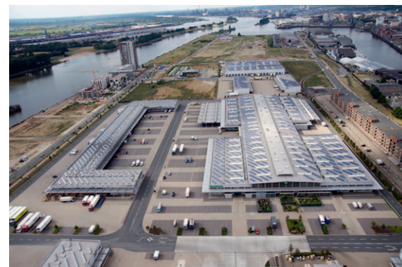
Eine Gesamtleistung von 1 Megawatt peak steuert die Photovoltaikanlage auf dem Großmarkt Bremen bei.
