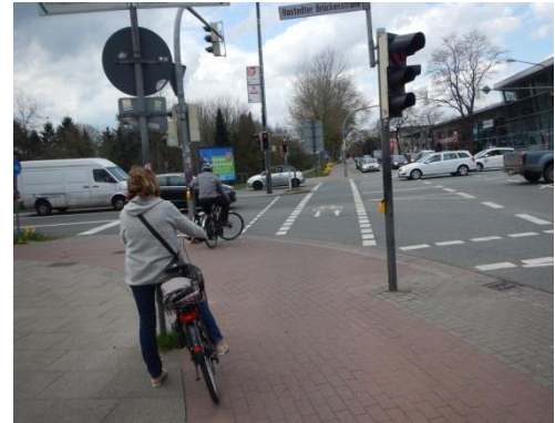
Bild 7-59 Furt im Verlauf des Zweirichtungsradschwerges Osterdeich über die Hastedter Brückenstraße
