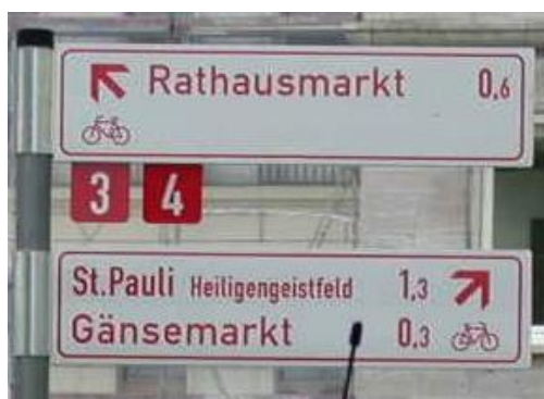
Bild 4-32 Integration einer Routennummer in die Radverkehrswegweisung (Hamburg)
