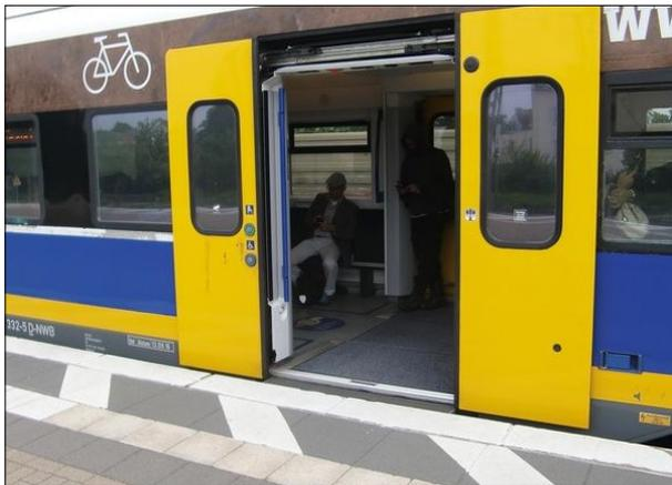
**Abbildung 5:** In Bremen-Walle ist das Ein- und Aussteigen in die Regio-S-Bahn mit nur einer kleinen Höhendifferenz zwischen dem Bahnsteig und der Trittstufe des Fahrzeugs bequem möglich.
