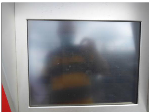
Abbildung 48: Der Bildschirm des DB-Fahrkartenautomaten in Bremen-Mahndorf an Gleis 2 war nur sehr schwer lesbar. Die Helligkeit der Anzeige ist bei Tageslicht nicht ausreichend.
