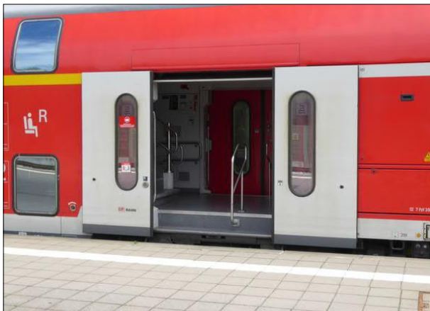
Abbildung 5: Auch an Bahnsteigen, die wie in Bremerhaven-Lehe eine Höhe von 76 cm über der Schienenoberkante aufweisen, ist an den meisten Türen kein stufenloser Einstieg in die Doppelstockwagen möglich.
