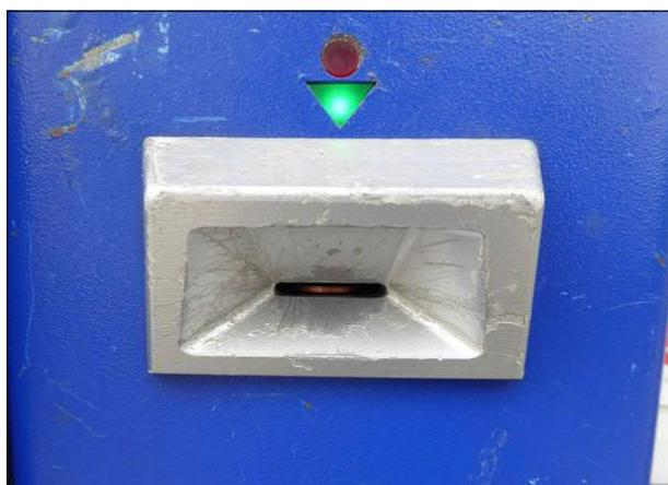
Abbildung 33: Der Schlitz des Entwerterns in Bremen Mühlenstraße war mit einer Münze verstopft und damit trotz grüner Funktionsleuchte unbenutzbar.
