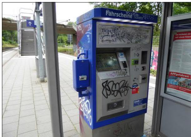
Abbildung 31: Der Fahrkartenautomat in Bremen-St. Magnus war umfangreich beschmieret. Außerdem war der Bildschirm stark beschädigt.
