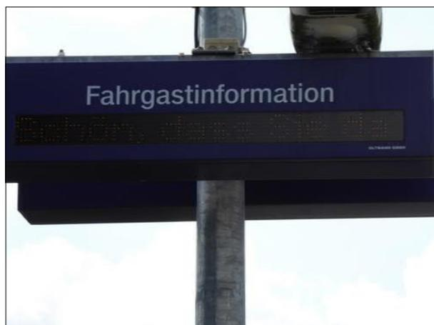
Abbildung 18: In einem DSA an Gleis 1 in Bremen-Mahndorf wurden die Informationen mit zu geringer Leuchtstärke dargestellt. Sie waren nur schwer lesbar.
