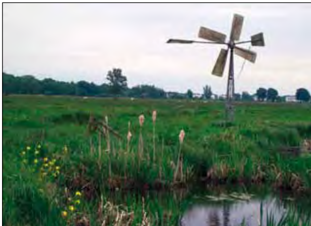
Regulierung des Grabenwasserstands in Grünlandgebieten und Zuwässerung mit Windschöpfwerken (hier im Hollerland)
