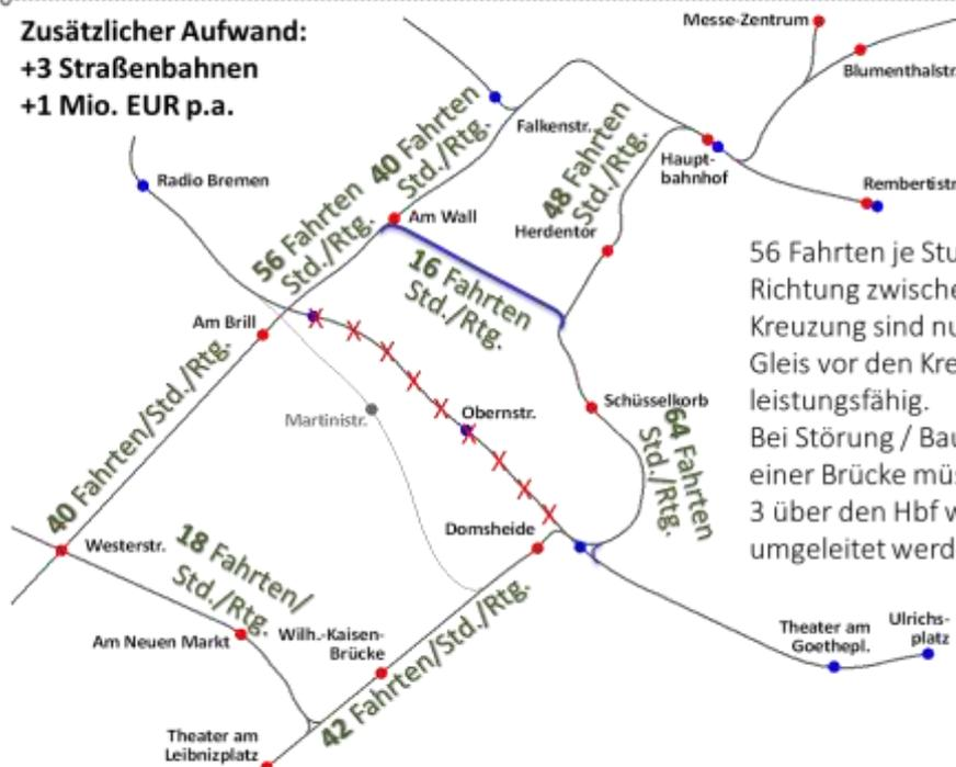
56 Fahrten je Stunde und Richtung zwischen Brill und AOK-Kreuzung sind nur mit einem 3. Gleis vor den Kreuzungen leistungsfähig. Bei Störung / Bauarbeiten auf einer Brücke müssen Linien 2 und 3 über den Hbf weiträumig umgeleitet werden.
