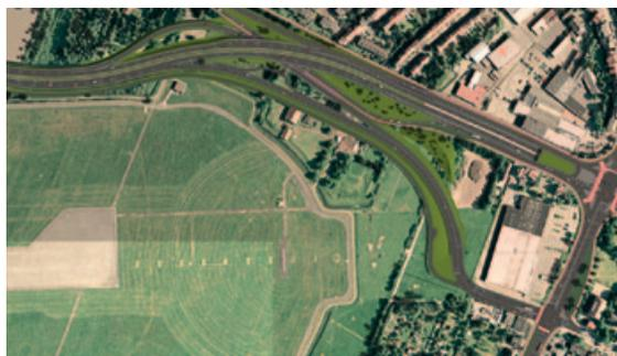
*Trasse des BA 2/2 gemäß Planfeststellungsbeschluss aus dem Jahr 2009*
