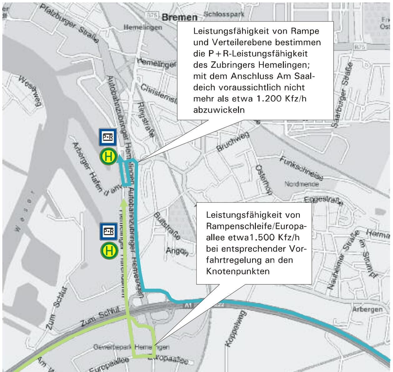
Bild 9: Vorzugsvariante bei der Erschließung des P + R-Standortes Hemelinger Hafen
