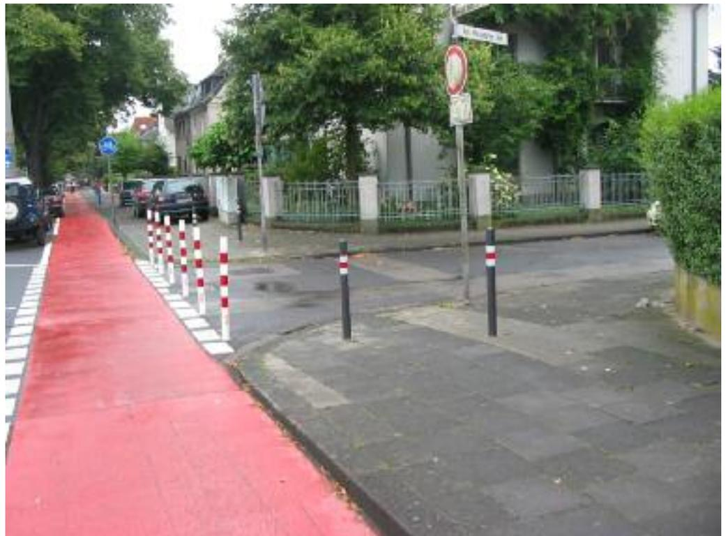
Bild 5: Beispiel für eine temporär abgesperrte Schutzzonenzufahrt mit Steckpfosten
