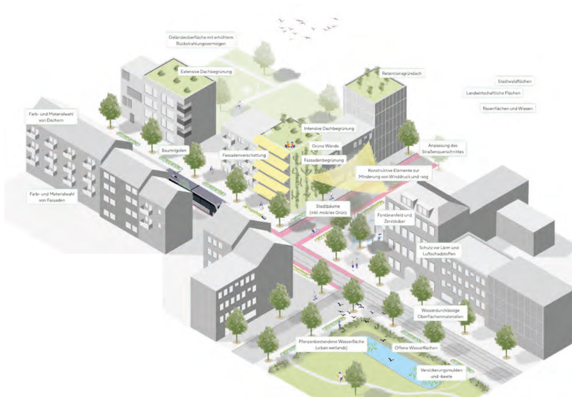
Abb. 71 Entwurfsbaukasten zum multiklimatischen Management des öffentlichen Stadtraums, Quelle: © MUST Städtebau (Projekt Multiklima)
