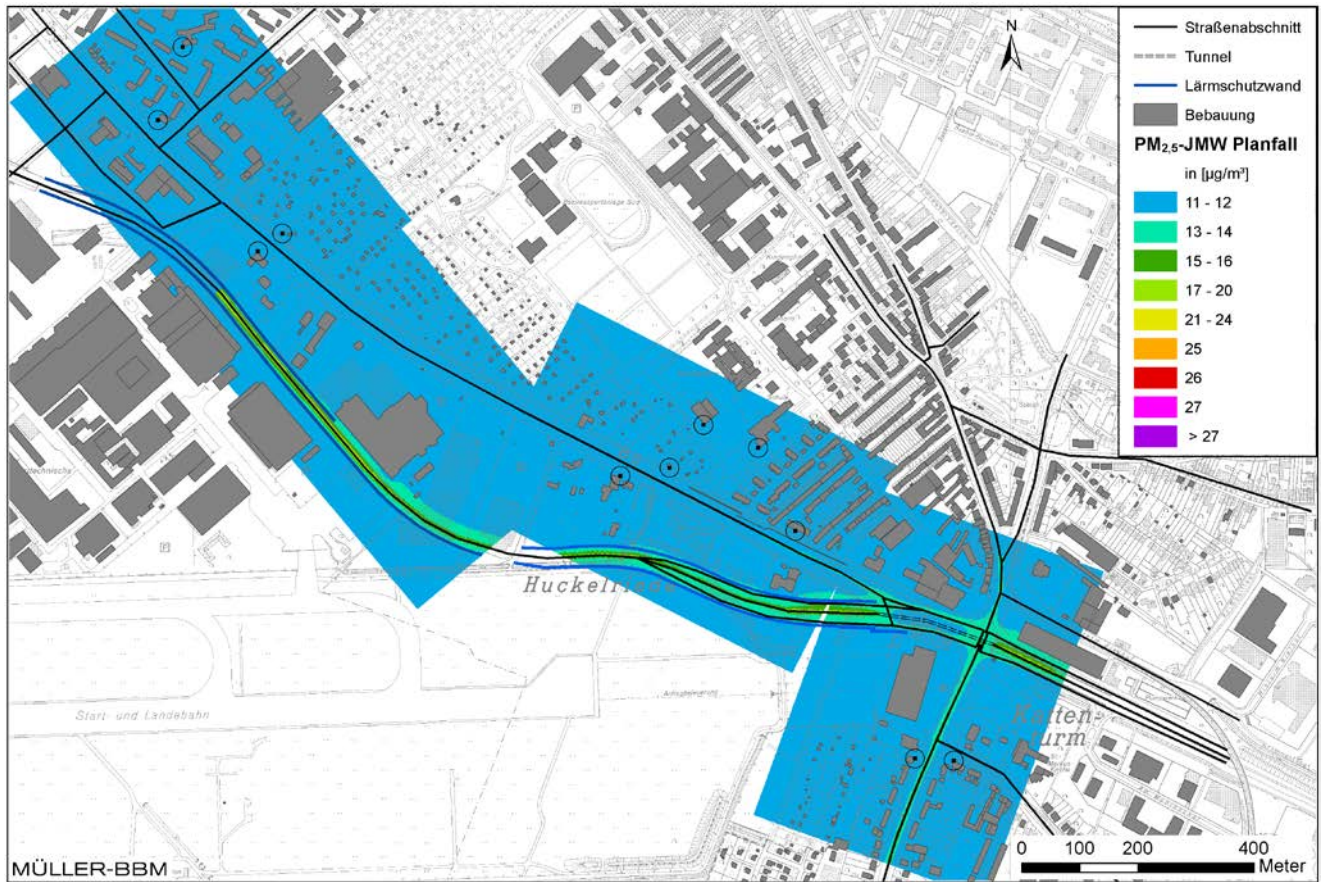
Abbildung 9. Planfall BA 2/2 Prognose 2030 – PM 2,5 -Immissionen (Jahresmittelwerte) bodennah, ermittelt mit einer Fahrzeugflotte des Jahres 2025.
