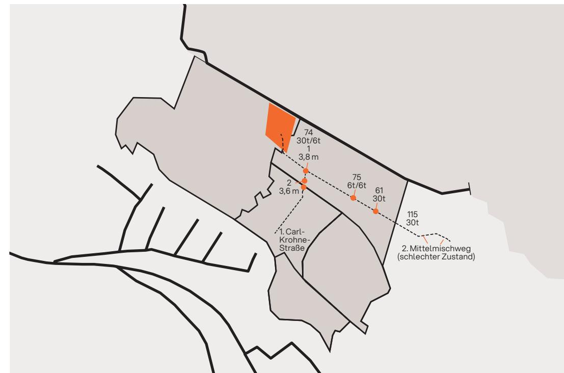
Abbildung 10: Zufahrtmöglichkeiten mit Markierungen der Brückenhöhen und Gewichtsbeschränkungen.
