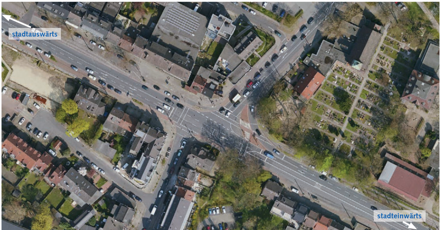
Abb. 10 Luftbild vom Knotenpunkt mit überdimensional verzogener Kreuzung, langen Räumzeiten in der Lichtsignalschaltung, unübersichtlicher Knotenpunktgeometrie, langen Fußwegen und großzügig angelegten Nebenanlagen. (Quelle: Freie Hansestadt Bremen)
