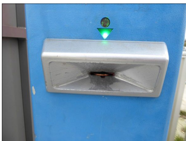
Abbildung 48: Der Entwerfer am Bahnsteig an Gleis 1 in Bremen-Mahndorf war mit einer Münze verstopft. Anders als durch den grünen Pfeil vermittelt, war eine Nutzung nicht möglich.
