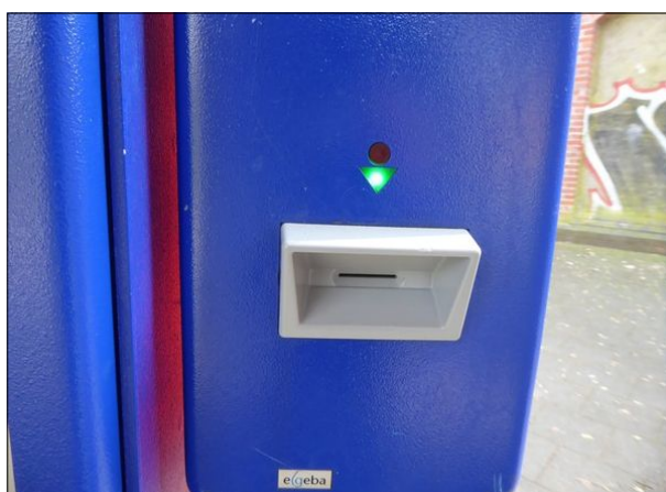
Abbildung 33: An einigen Stationen wurden die Schlitze der Entwerter gewechselt, so dass ein Verstopfen durch Münzen nicht mehr möglich ist. Zu sehen ist hier ein Gerät in Bremen-Lesum.
