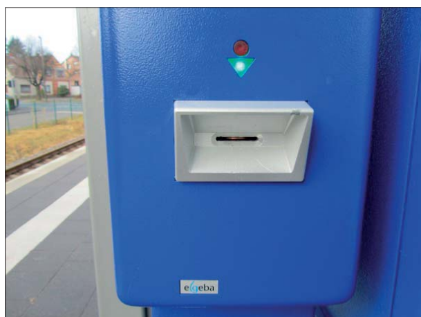
Abbildung 30: Trotz des durch eine Münze verstopften Schlitzes signalisiert der grün leuchtende Pfeil die Betriebsbereitschaft dieses Entwerfers in Bremen Kreinsloger.
