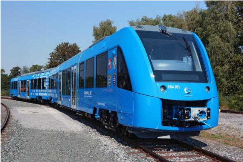
**Abb. 4:** Wasserstofftriebwagen im Weser-Elbe-Netz [Foto: Alstom AG]
