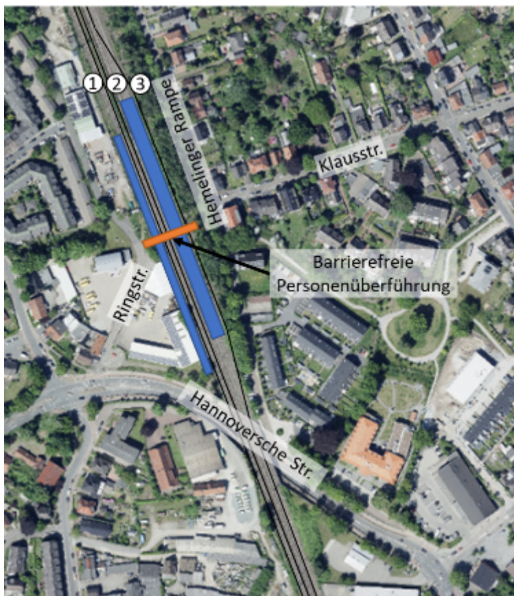
Abb. 15: Neue Vorzugsvariante Bremen-Hemelingen (ein Außenbahnsteig und ein Mittelbahnsteig nördlich der Eisenbahnüberführung Hannoversche Straße)
