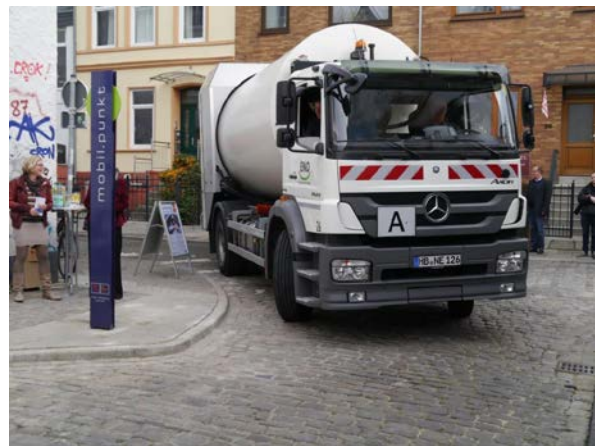
Abb. 8: Beitrag zur Rettungssicherheit: Gehwegnasen an Einmündungen verhindern Falschparken in den Einmündungen (Schmidtstr./Hollerstr.)
