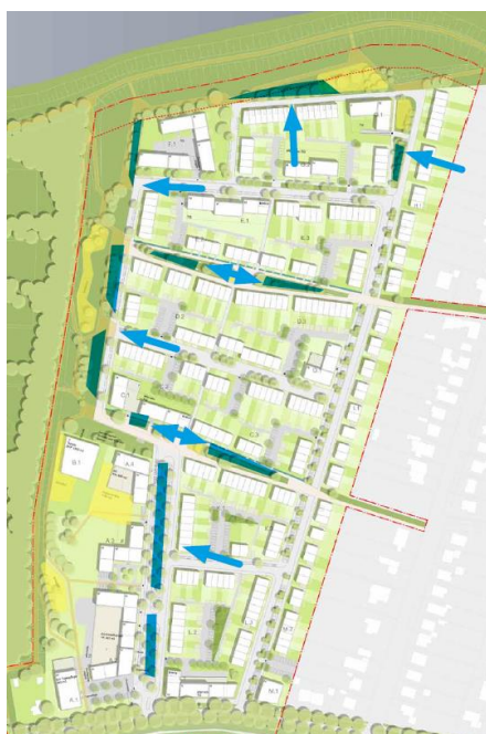
Abbildung 3: Bei der Grundsanierung der Münchener Straße wurden Maßnahmen für eine Starkregenvorsorge und einer Verbesserung des Bioklimas umgesetzt. Obwohl das Platzangebot im Straßenraum nicht großzügig und die Bodenverhältnisse für eine Versickerung nicht optimal waren, konnte ein Raum für die Rückhaltung von Niederschlagswasser im Straßenraum für den Ereignisfall Starkregen geschaffen werden. Die Parkstreifen und Baumbeste sind tiefer angelegt als die umgebenden Rad- und Fußwege sowie die Fahrbahn. Zusätzlich dienen die Baumbeste und die Parkflächen der Teilversickerung von Niederschlagswasser. Für eine Begrünung und Beschattung des Straßenraumes wurden rund 45 neue Bäume (Feldahorn) gepflanzt. (unten: Titel eines Artikels im WeserKurier vom 25.10.2014) (Bildquelle: Amt für Straßen und Verkehr)
