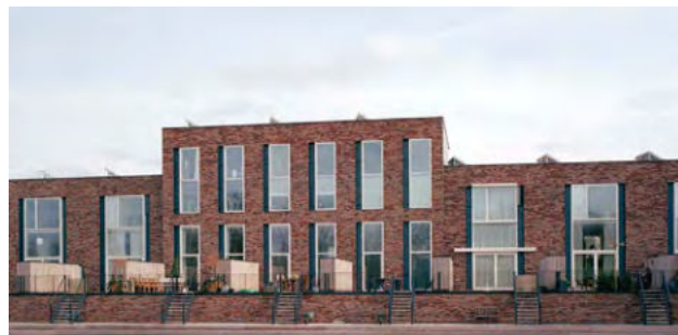
Abb. 62: Durch die Fassadengestaltung können Reihenhäuser zu Gebäudegruppen zusammengefasst werden. Diese Methode ist bevorzugt im Randbereich und an den Grünen Angern anzuwenden. Die Wohnungstrennwände werden nicht betont, sondern "verschwinden" in der Fassadengestaltung.
