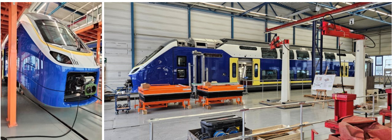
Abb. 6: Triebwagen Coradia Stream HC für das Netz EBN in Produktion in Salzgitter November 2023, [Bilder: LNVG, T. Nawrocki]
