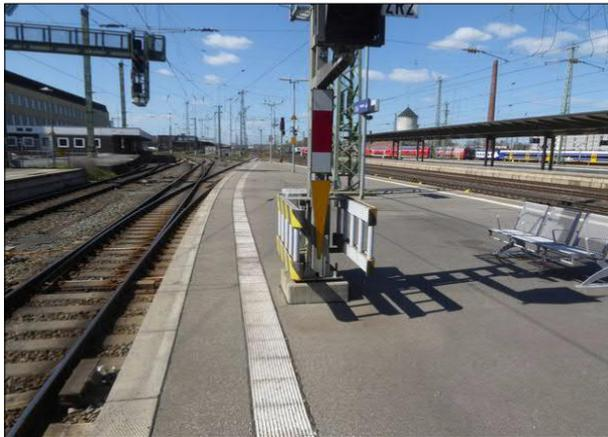
Abbildung 5: Der Abstand zwischen dem Leitstreifen und diesem Signal in Bremen Hbf an Gleis 2 ist mit weniger als 15 cm viel zu klein. Das Blindenleitsystem muss in dem Bereich um das Signal herum geführt werden.
