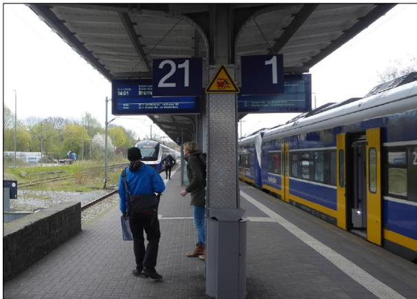
Abbildung 16: Der Blick vom Zugang auf die Zugzielanzeiger in Bremen-Vegesack wird von den großen Gleisnummernschildern eingeschränkt.
