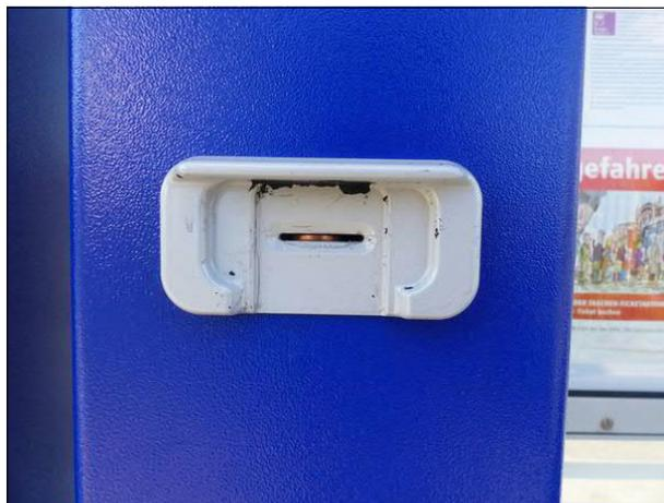
Abbildung 32: In Bremen Mühlenstraße war der Entwerter mit einer Münze verstopft. Dieser neue Entwerter hat einen höheren Schlitz als das Vorgängermodell, so dass Münzen hineinpassen. Zudem ist die Stempeltechnik offenbar sensibler und damit weniger fahrgastfreundlich.
