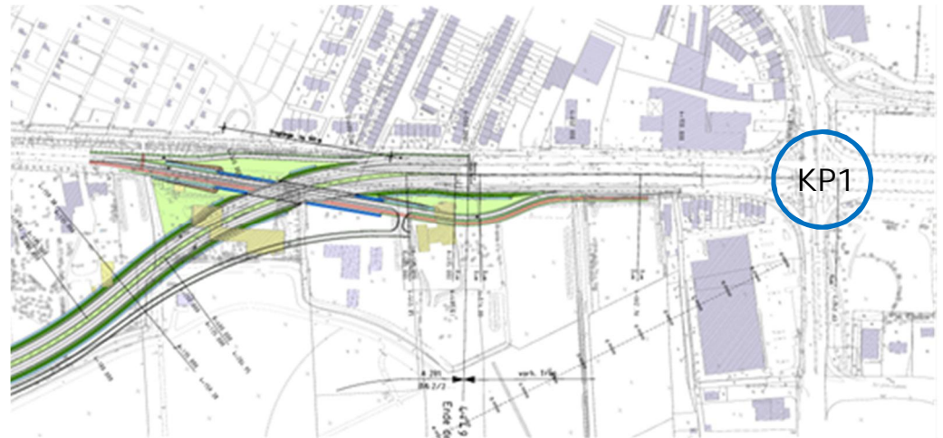
Abb. 8 Anschluss an den Trog Neuenlander Straße ohne Ausbau des Knotenpunktes Neuenlander Straße / Kattenturmer Heerstraße (KP 1)
