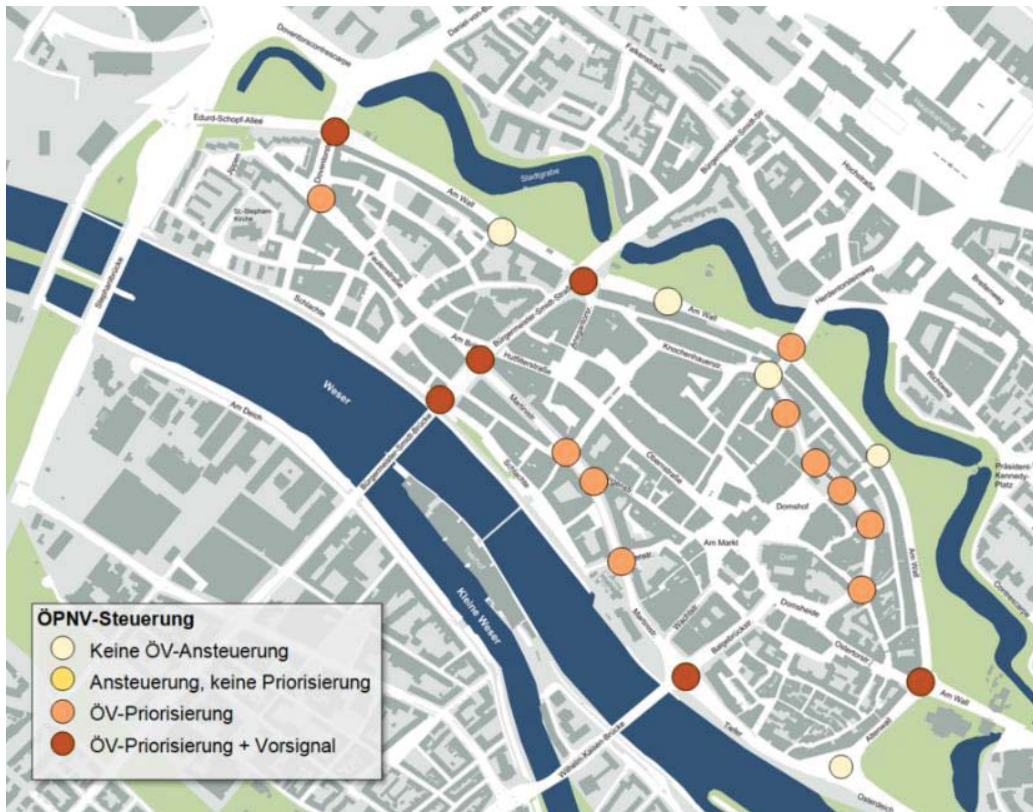
Abbildung 4-50 Lichtsignalanlagen in der Innenstadt – Eingesetzte Steuerverfahren, Quelle: Eigene Darstellung ASV
