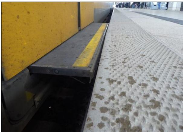
**Abbildung 5:** Diese Trittstufe einer Regio-S-Bahn war an Gleis 5 in Bremen Hbf exakt auf Bahnsteigniveau. An mehreren Stationen traten allerdings Höhenunterschiede von bis zu 7 cm zwischen der Bahnsteigkante und den Trittstufen auf.
