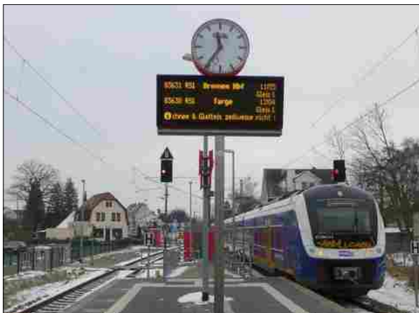
Abbildung 14: Die Zugzielanzeiger auf dem Bahnsteig in Bremen-Aumund blendeten auch verspätete Züge zur fahrplangemäßen Abfahrtszeit aus, obwohl diese noch nicht einmal im Bahnhof eingetroffen waren.
