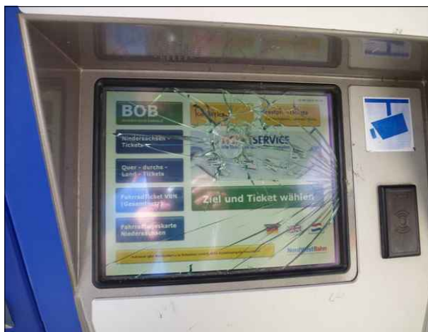
Abbildung 32: Der Bildschirm des Automaten in Bremen-St. Magnus war stark beschädigt. Er funktionierte aber noch.
