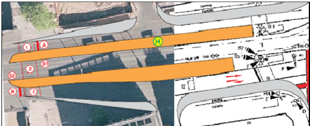
Bild 20: Die dreigeteilte Fußgängerschutzanlage in Höhe der „Schlachte“
